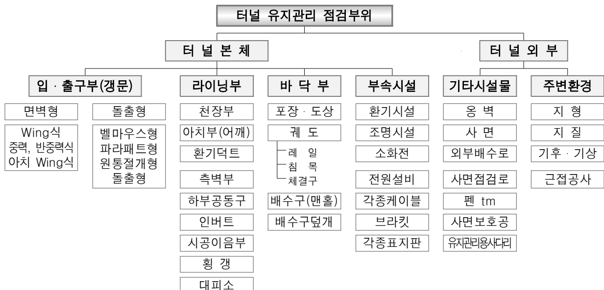
〈그림 7.6〉 터널의 유지관리를 위한 점검부위의 구분
