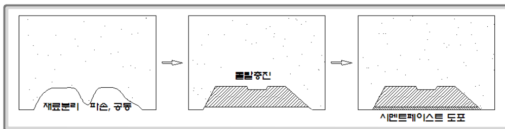
〈그림 7.5〉 단면보수(철근비노출부) 공법 개요도
